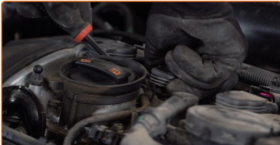
Heben Sie die Zündspule an (4 Stück). Benutzen Sie ein Brecheisen.
