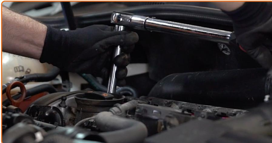
Schrauben Sie die neuen Zündkerzen an und ziehen Sie diese fest. Verwenden Sie die Zündkerzennuss # 16. Verwenden Sie einen Drehmomentschlüssel. Ziehen Sie ihn mit 27 Nm Drehmoment fest.
