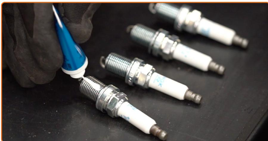
Tragen Sie eine dünne Schicht eines speziellen Hochtemperatur-Anti-Seize-Schmiermittels auf das Gewinde der neuen Zündkerzen auf. Behandeln Sie die Oberfläche der Anschlüsse der neuen Zündkerzen. Benutzen Sie ein Hochtemperaturzündkerzenfett.
