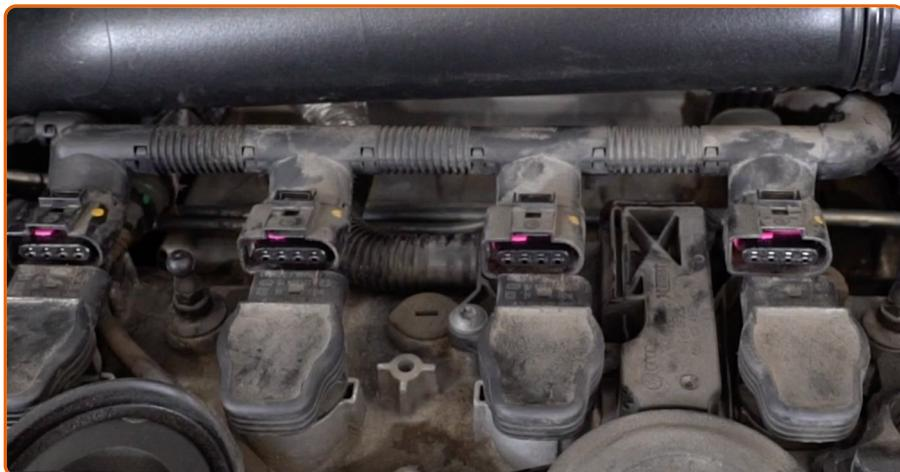
Heben Sie ein wenig die Verkabelung der Zündspulen an und legen Sie sie zur Seite.
