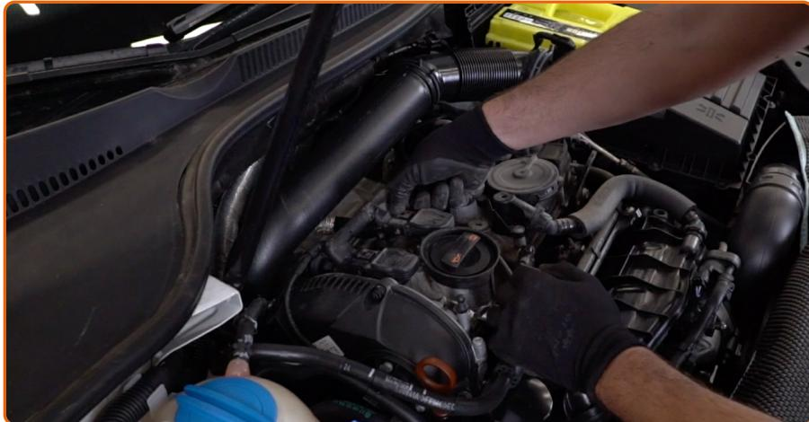
Lösen Sie die Steckverbindung von den Zündspulen.
