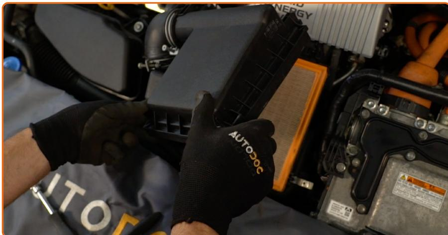
Heben Sie die Abdeckung des Luftfiltergehäuses leicht an.
