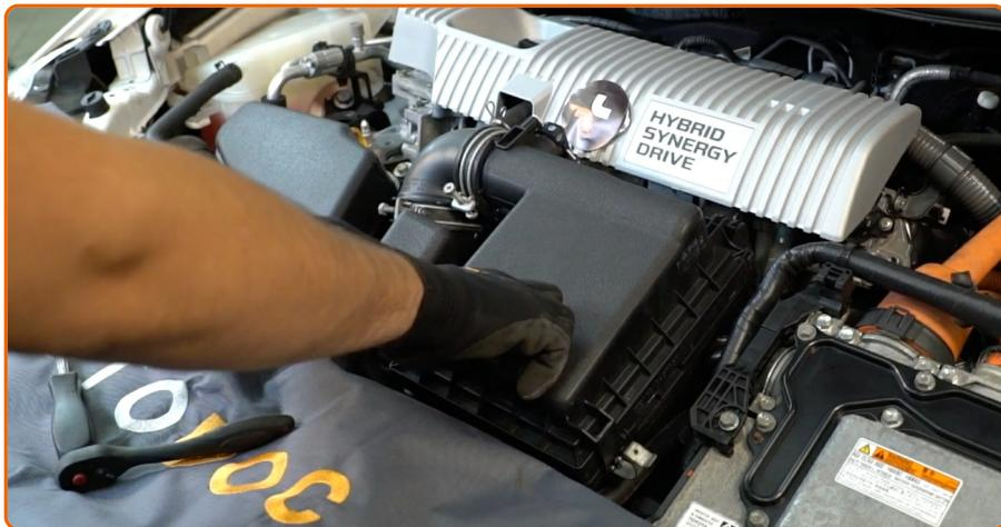
Setzen Sie die Luftfilterabdeckung ein. Befestigen Sie diese.
