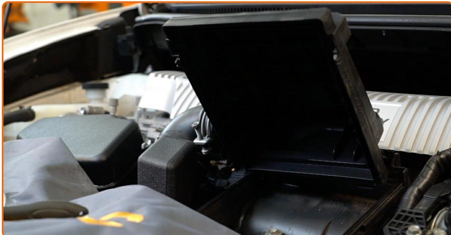
Entfernen Sie das Mikrofasertuch vom Luftansaugschlauch.
