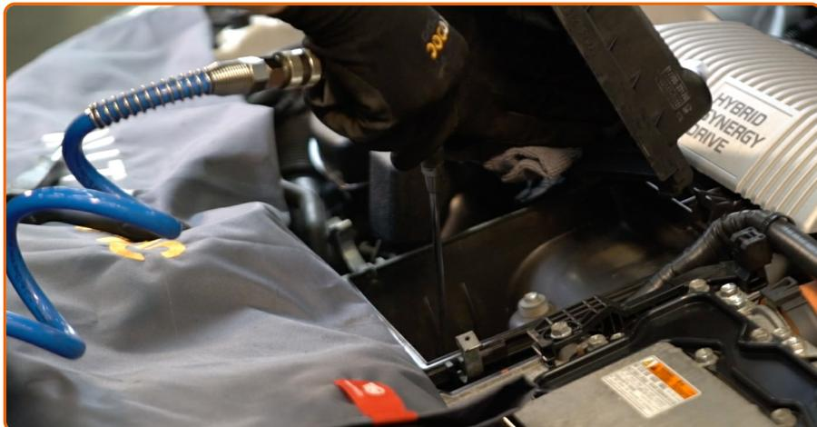
Reinigen Sie die Abdeckung und das Gehäuse des Luftfilters.
