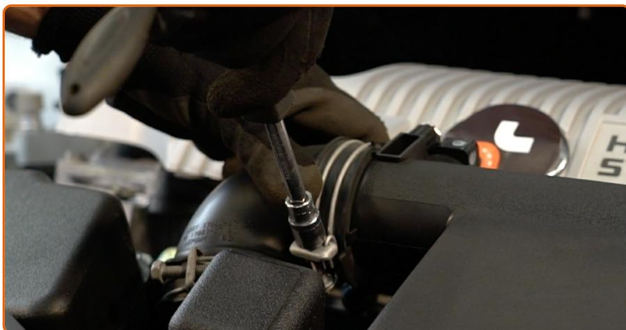
Ziehen Sie die Klemme am Luftansaugschlauch fest. Verwenden Sie Stecknuss Nr. 10.
