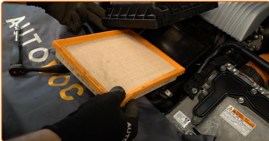
Entfernen Sie das Filterelement aus dem Filtergehäuse.
