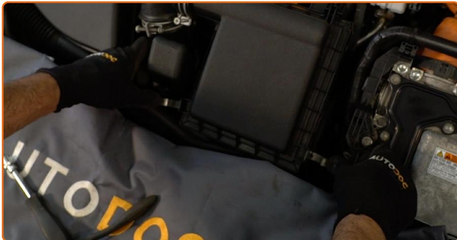
Lösen Sie die Befestigungsclips der Luftfilterabdeckung.
