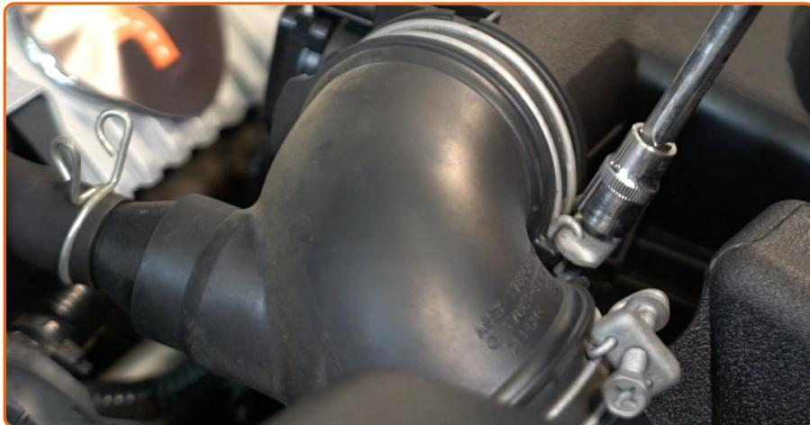
Lösen Sie die Luftansaugschlauchklemme. Verwenden Sie Stecknuss Nr. 10. Verwenden Sie einen Ratschenschlüssel.
