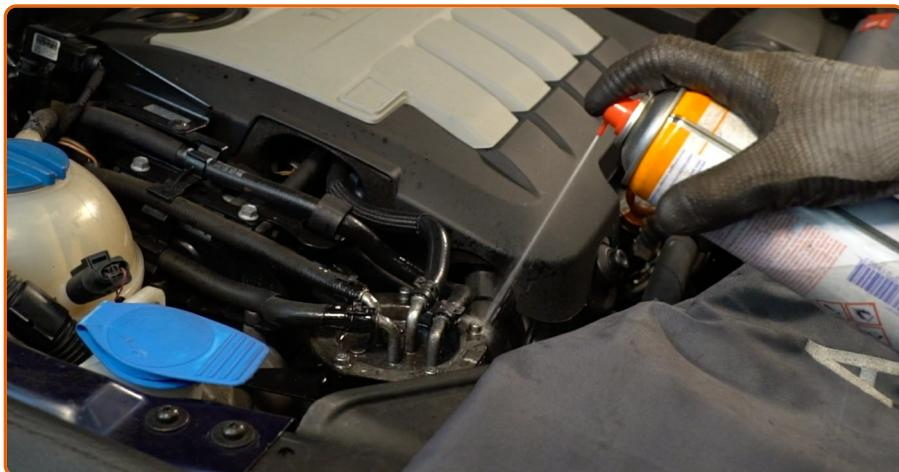
Reinigen Sie den Kraftstofffilter. Verwenden Sie Allzweckreinigungsspray.
