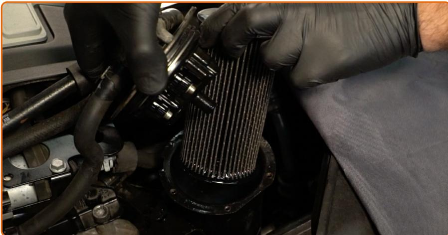
Entfernen Sie den Kraftstofffilter.
