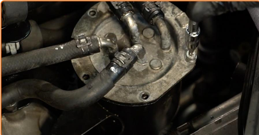
Installieren Sie den Deckel des Kraftstofffiltergehäuse und ziehen Sie ihn an. Verwenden Sie den Torx T20. Verwenden Sie einen Ratschenschlüssel.
