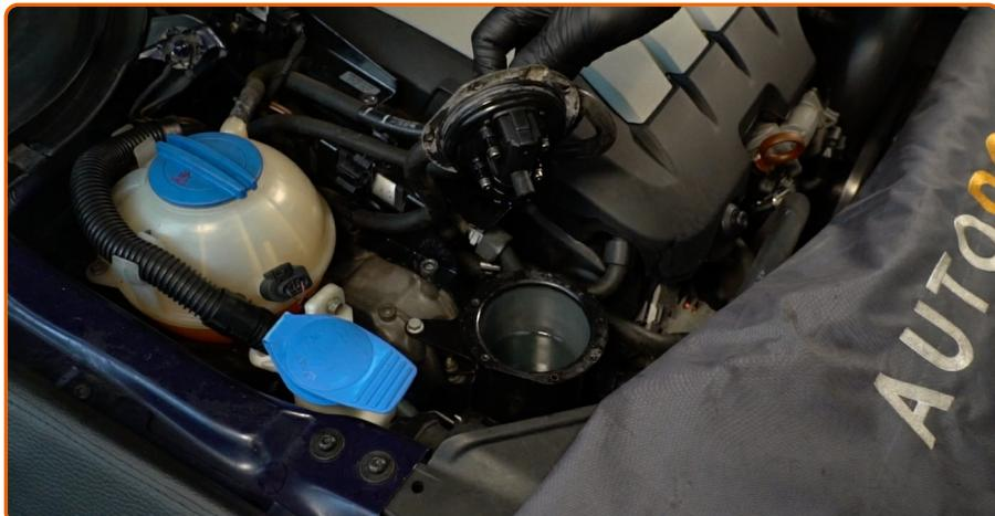
Entfernen Sie das Mikrofasertuch vom Kraftstofffiltergehäuse.
