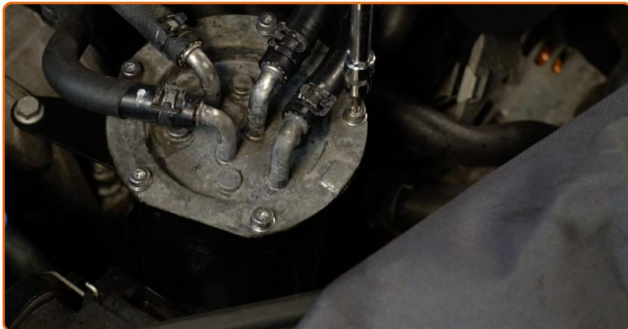
Schrauben Sie die Befestigungen vom Deckel des Kraftstofffiltergehäuses ab. Verwenden Sie den Torx T20. Verwenden Sie einen Ratschenschlüssel.
