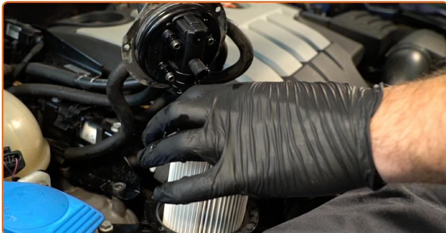
Installieren Sie einen neuen Kraftstofffilter.
