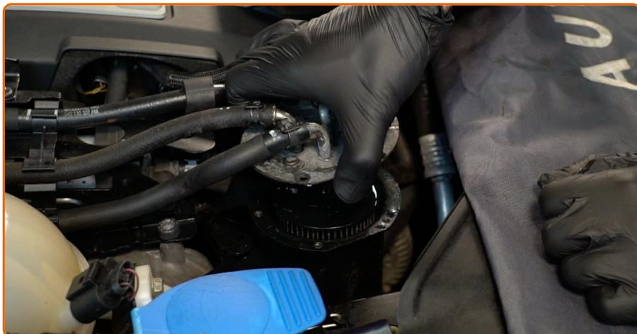
Heben Sie den Kraftstofffilterdeckel ein wenig an. Benutzen Sie ein Brecheisen.
