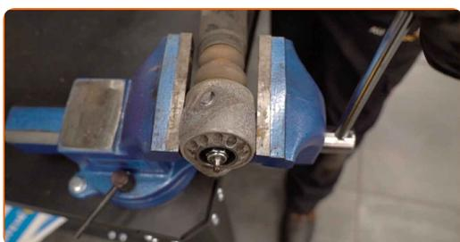
**15** Entfernen Sie die Befestigung der Stoßdämpferkolbenstange. Verwenden Sie Ring-Gabelschlüssel Nr. 17. Benutzen Sie einen Rollgabelschlüssel.
