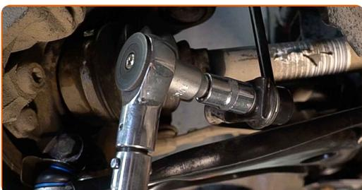
**12** Ziehen Sie das Befestigungselement an, das die Druckstange mit dem Federbein verbindet. Verwenden Sie Stecknuss Nr. 16. Verwenden Sie einen Drehmomentschlüssel. Ziehen Sie ihn mit 43 Nm Drehmoment fest.
