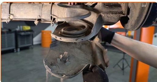
**9** Stützen Sie die Verbundlenkerachse. Benutzen Sie einen hydraulischen Getriebeheber.
