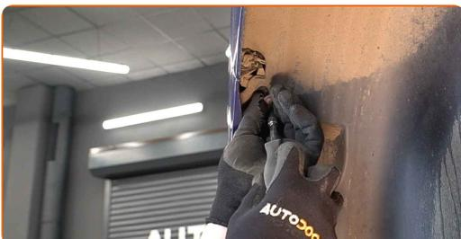
**7** Entfernen Sie die Radkastenabdeckung.
