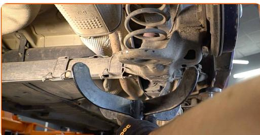
**10.1** Reinigen Sie die Stoßdämpferbefestigungen.
