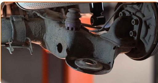
**14** Bauen Sie die Spiralfeder zusammen mit den Gummilager in deren Aufnahmen ein.
