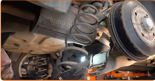
**12** Reinigen Sie die Aufnahmen der Spiralfedern. Benutzen Sie eine Drahtbürste. Benutzen Sie WD-40-Spray.
