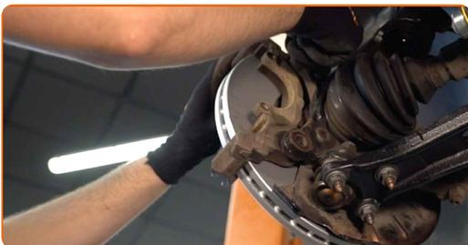
**24** Befestigen Sie die Bremssattelhalterung. Verwenden Sie Stecknuss Nr. 21. Verwenden Sie einen Drehmomentschlüssel. Ziehen Sie ihn mit 190 Nm Drehmoment fest.
