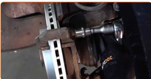
**25** Behandeln Sie den Bremssattel-Kolben. Benutzen Sie einen Bremsenreiniger.
