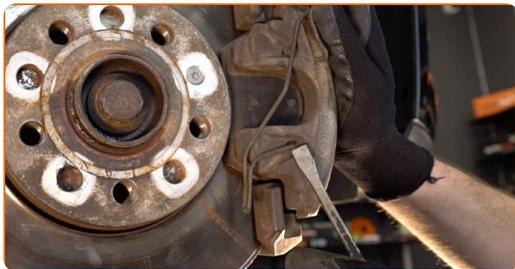
**11** Entfernen Sie den Bremssattel.
