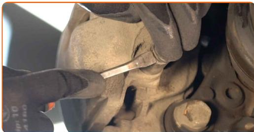
**8** Schrauben Sie die Befestigung des Bremssattels ab. Verwenden Sie Inbusschlüssel Nr. H7. Verwenden Sie einen Ratschenschlüssel.
