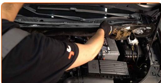
**6** Reinigen Sie die Befestigungselemente der oberen Federbeinhalterung. Benutzen Sie eine Drahtbürste. Benutzen Sie Sie WD-40-Spray.
