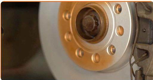
**68** Die Bremsscheibenoberfläche reinigen. Benutzen Sie einen Bremsenreiniger.
