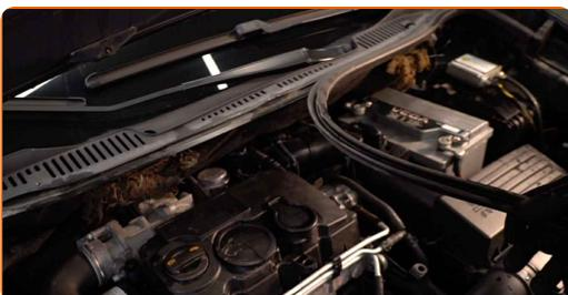
**4** Lösen Sie die Befestigungen von der Spritzschutzwand/Wasserkastenabdeckung. Verwenden Sie den Torx T30.
