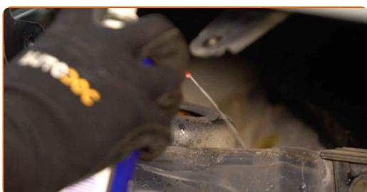
**7** Lösen Sie die obere Befestigung des Domlagers. Verwenden Sie Stecknuss Nr. 13. Verwenden Sie einen Ratschenschlüssel.
