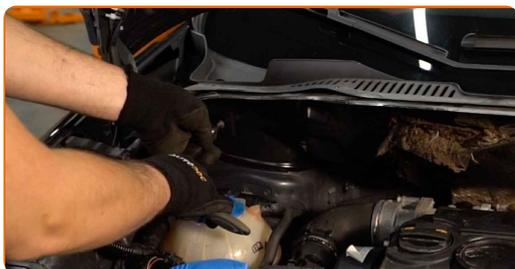
**5** Entfernen Sie die Spritzschutzwand/Wasserkastenabdeckung.
