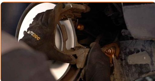
**22** Befestigen Sie die Bremssattelhalterung. Benutzen Sie den XZN #14. Verwenden Sie einen Drehmomentschlüssel. Ziehen Sie ihn mit 90 Nm Drehmoment fest.+90°
