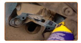
Bringen Sie das Befestigungselement der Auspuffanlage an.
