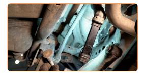
Entfernen Sie die Befestigungsschraube. Verwenden Sie Stecknuss Nr. 21.
