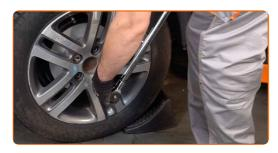
Entfernen Sie den Wagenheber sowie die Unterlegkeile.
