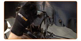
Reinigen Sie die Montagebohrungen und die Gewinde des Querlenkers. Benutzen Sie eine Drahtbürste. Benutzen Sie WD-40-Spray.
