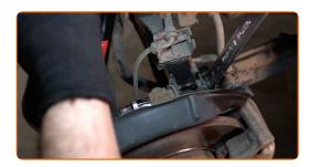
Entfernen Sie die Halterung der ABS-Sensorverdrahtung vom Oberarm. Benutzen Sie ein Brecheisen.
