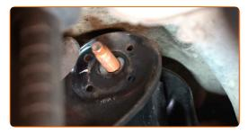
Schrauben Sie das Befestigungselement ein, das den Querlenker mit dem hinteren Hilfsrahmen verbindet. Verwenden Sie Stecknuss Nr. 18. Verwenden Sie Ring-Gabelschlüssel Nr. 18.
