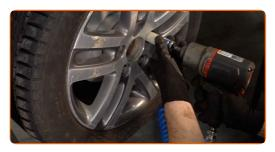
Senken Sie das Auto und ziehen Sie die Radschrauben über Kreuz an. Verwenden Sie einen 50 Drehmomentschlüssel. Ziehen Sie ihn mit 120 Nm Drehmoment fest.
