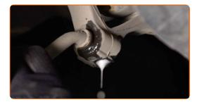
Entfernen Sie das Befestigungselement der Auspuffanlage. Benutzen Sie ein Brecheisen.
