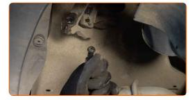
Entfernen Sie die Befestigungsschraube. Benutzen Sie ein Brecheisen. Benutzen Sie einen Hammer.
