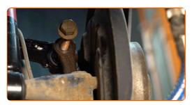
Schrauben Sie die Befestigungen ein, die den Querlenker mit dem Hinterachsgelenk verbinden. Verwenden Sie Stecknuss Nr. 21. Verwenden Sie Ring-Gabelschlüssel Nr. 21.
