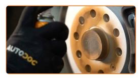
Die Bremsscheibenoberfläche reinigen. Benutzen Sie einen Bremsenreiniger.
