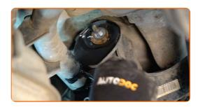
Entfernen Sie die Befestigungsschraube. Benutzen Sie ein Brecheisen. Benutzen Sie einen Hammer.
