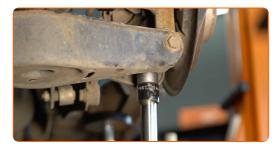
Ziehen Sie das Befestigungslement an, das den Querlenker mit dem hinteren Hilfsrahmen verbindet. Verwenden Sie Ring-Gabelschlüssel Nr. 18. Verwenden Sie Stecknuss Nr. 18. Verwenden Sie einen Drehmomentschlüssel. Ziehen Sie ihn mit 95 Nm Drehmoment fest.
