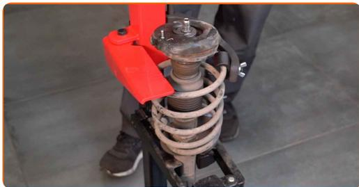
**32** Entfernen Sie die Stangenmutter des Federkolben. Verwenden Sie Stecknuss Nr. 19. Verwenden Sie Inbusschlüssel Nr. H7. Verwenden Sie einen Ratschenschlüssel.
