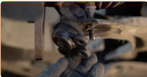
**21** Lösen Sie das Befestigungselement, welches die Antriebswelle mit der Radnabe verbindet. Verwenden Sie Stecknuss Nr. 30.
