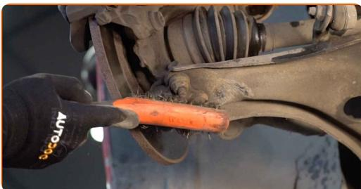
**19** Lösen Sie das Befestigungselement, welches das Kugelgelenk am Federungsquerlenker befestigt. Verwenden Sie Stecknuss Nr. 16. Verwenden Sie Ring-Gabelschlüssel Nr. 16. Verwenden Sie ein Windeisen.
