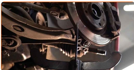
**26** Lösen Sie das untere Befestigungselement, das das Federbein mit dem Achsschenkel verbindet. Verwenden Sie eine spezielle Schraubnuss, um den Stoßdämpfer zu entfernen. Verwenden Sie einen Ratschenschlüssel.
