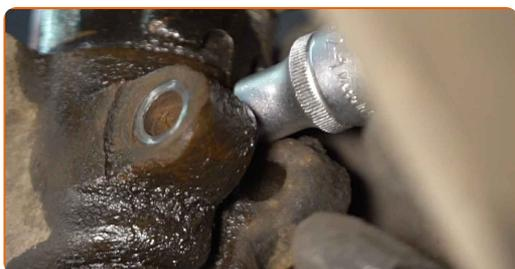
**27** Ziehen Sie den Achsschenkel vom Dämpferbein ab. Benutzen Sie einen Hammer.
