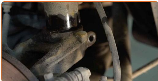
**25** Stützen Sie die Achsschenkel auf. Benutzen Sie einen hydraulischen Getriebeheber.
