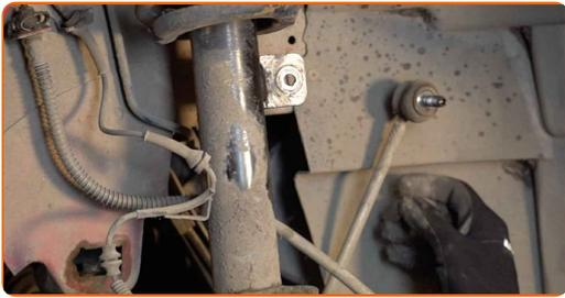
**17** Die Befestigungselemente, die das Federbein mit dem Achsschenkel verbinden, reinigen. Benutzen Sie eine Drahtbürste. Benutzen Sie WD-40-Spray.
