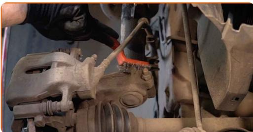
**18** Reinigen Sie alle Verbindungen des Querlenkers. Benutzen Sie eine Drahtbürste. Benutzen Sie WD-40-Spray.
