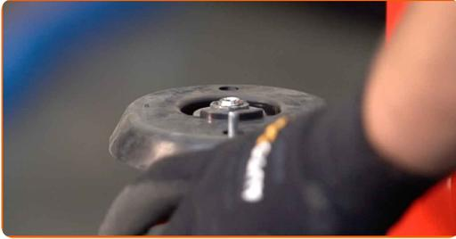
**39** Ziehen Sie die Federbeinkolbenstangenmutter an. Verwenden Sie Inbusschlüssel Nr. H7. Verwenden Sie Stecknuss Nr. 19. Verwenden Sie einen Drehmomentschlüssel. Ziehen Sie ihn mit 60 Nm Drehmoment fest.
