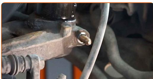
**47** Schrauben Sie das Befestigungselement ein, das das Federbein mit dem Achsschenkel verbindet. Verwenden Sie Stecknuss Nr. 16.
