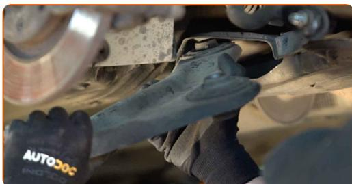
**17** Reinigen Sie die Montagebohrungen und die Gewinde des Querlenkers. Benutzen Sie eine Drahtbürste.
