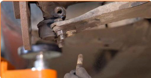
**9** Stützen Sie die Achsschenkel auf. Benutzen Sie einen hydraulischen Getriebeheber.
