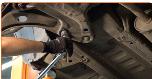
**14** Entfernen Sie die Befestigungsschrauben. Verwenden Sie einen Splintentreiber. Benutzen Sie einen Hammer.
