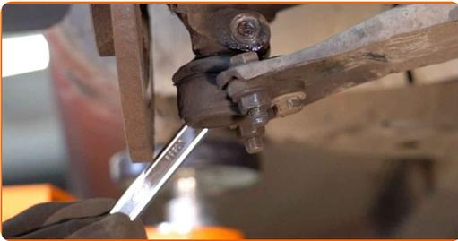
**8** Entfernen Sie die Befestigungsschraube.
