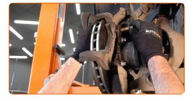
Befestigen Sie die Bremssattelhalterung. Verwenden Sie Stecknuss Nr. 19. Verwenden Sie einen Drehmomentschlüssel. Ziehen Sie ihn mit 152 Nm Drehmoment fest.
