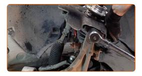
Entfernen Sie den Träger unter dem Achsschenkel.
