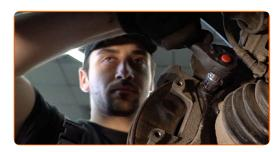
16 Entfernen Sie die Sattelhalterung.
