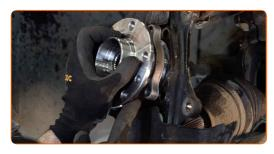
Ziehen Sie die Nabe hindurch. Verwenden Sie Stecknuss Nr. E14. Verwenden Sie einen Drehmomentschlüssel. Ziehen Sie ihn mit 112 Nm Drehmoment fest.
