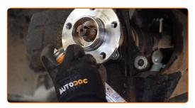
Schrauben Sie die Nabenkontermutter des Rads an.
