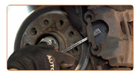
Entfernen Sie den Bremssattel.
