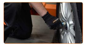
Entfernen Sie die Schutzkappe des Nabenlagers. Verwenden Sie einen flachen Schraubendreher.
