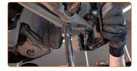
Verbinden Sie das Kugelgelenk mit dem Achsschenkel. Verbinden Sie den Unterarm mit dem Achsschenkel.
