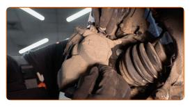
Bauen Sie die Bremssattel-Haltefeder ein. Benutzen Sie ein Brecheisen.
