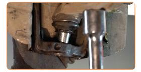
Entfernen Sie den Träger unter dem Arm.
