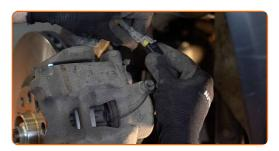
Installieren Sie die Staubschutzkappen der Bremssattel-Führungsstifte.
