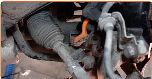
**9** Drehen Sie die Befestigungen heraus, die die Druckstange mit dem Stabilisator verbinden. Verwenden Sie Ring-Gabelschlüssel Nr. 18. Verwenden Sie Inbusschlüssel Nr. H6.
