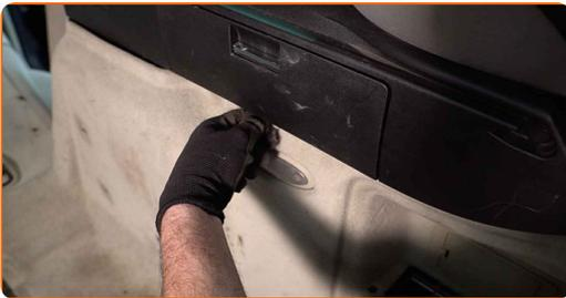
**88** Schrauben Sie das Befestigungselement der Seitenauskleidung des Kofferraums ein. Verwenden Sie den Torx T25. Verwenden Sie einen Ratschenschlüssel.
