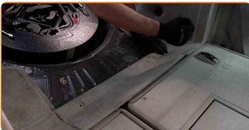
95 Bringen Sie die Clips der unteren Auskleidung des vorderen Kofferraumbereichs an.
