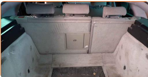
98 Setzen Sie die untere Kofferraumverkleidung ab.
