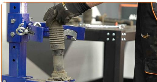
50 Entnehmen Sie den alten Stoßdämpfer aus dem hydraulischen Spiralfederspanner.
