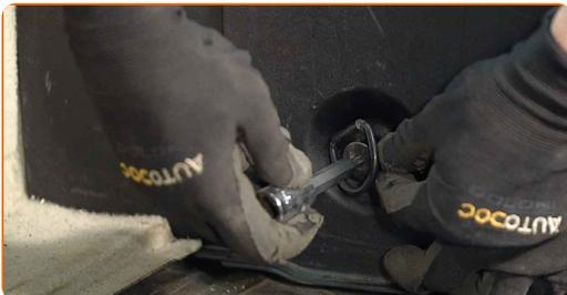
**94** Bringen Sie die untere Auskleidung des vorderen Kofferraumbereichs an.
