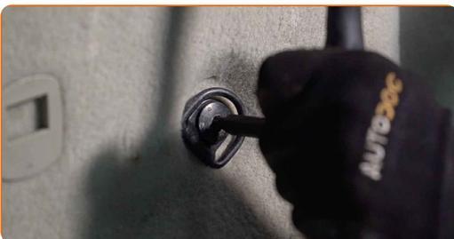
**89** Bringen Sie die Abdeckung der Seitenauskleidung des Kofferraums an.
