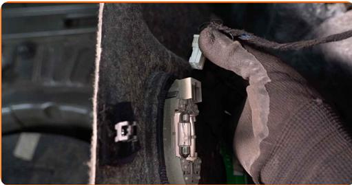
**87** Bringen Sie die Clips der Seitenauskleidung des Kofferraums an.
