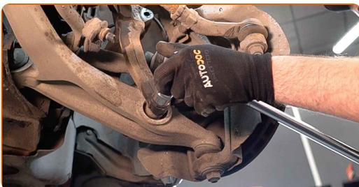
**15** Entfernen Sie die Befestigungsschraube.
