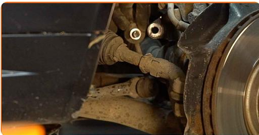
**13** Schrauben Sie die Befestigungsschraube heraus, die das Federbein mit der Stoßdämpfergabel verbindet. Verwenden Sie Stecknuss Nr. 18. Verwenden Sie ein Windeisen.
