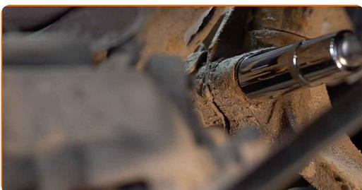
**14** Schrauben Sie die Befestigungsschraube heraus, die die Stoßdämpfergabel mit dem unteren Querlenker verbindet. Verwenden Sie Stecknuss Nr. 21. Verwenden Sie ein Windeisen.
