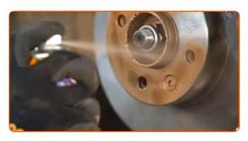
Die Bremsscheibenoberfläche reinigen. Benutzen Sie einen Bremsenreiniger.
