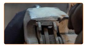
Entfernen Sie die Halteklammer der Bremsbeläge.
