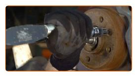
Entfernen Sie die Bremsscheibe.
