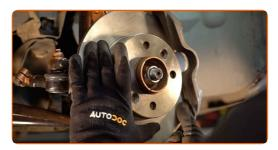
Ziehen Sie die Befestigung der Bremsscheibe fest. Verwenden Sie den Torx T30. Verwenden Sie einen Drehmomentschlüssel. Ziehen Sie ihn mit 15 Nm Drehmoment fest.
