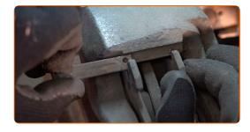
10 Entfernen Sie die Bremsbeläge.
