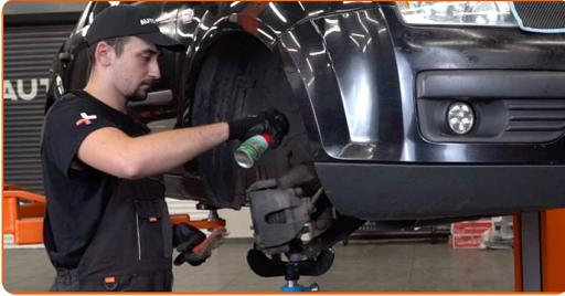
43 Installieren Sie das Federbein am Radlauf.
