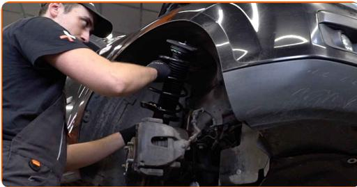
44 Sichern Sie die oberen Befestigungen des Federbeines (3 Stück). Schrauben Sie diese nicht fest.
