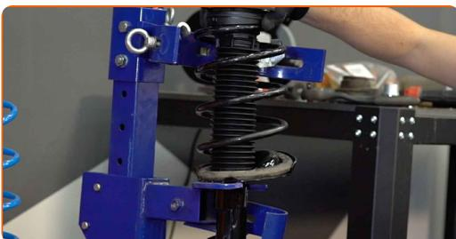
42 Reinigen Sie die Anbringungssitze des Federbeins. Benutzen Sie eine Drahtbürste. Benutzen Sie WD-40-Spray.
