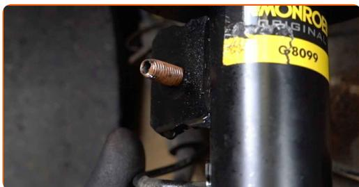
**12** Ziehen Sie das Befestigungselement an, das die Druckstange mit dem Federbein verbindet. Verwenden Sie Stecknuss Nr. 17. Verwenden Sie einen Drehmomentschlüssel. Ziehen Sie ihn mit 43 Nm Drehmoment fest.
