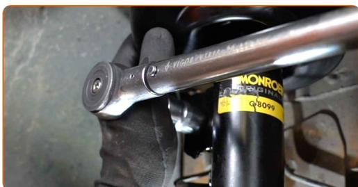
**13** Ziehen Sie das Befestigungselement an, das die Druckstange mit dem Stabilisator verbindet. Verwenden Sie Stecknuss Nr. 17. Verwenden Sie einen Drehmomentschlüssel. Ziehen Sie ihn mit 43 Nm Drehmoment fest.
