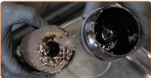
**14** Den Dichtungsring des Ölfilterdeckels entfernen. Verwenden Sie einen flachen Schraubendreher.
