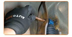
Schrauben Sie das obere Befestigungselement des Stoßdämpfers ein. Verwenden Sie Ring-Gabelschlüssel Nr. 16. Verwenden Sie Stecknuss Nr. 16. Verwenden Sie einen Ratschenschlüssel.
