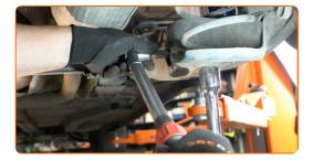
Die Montage unter dem Hinterachsträger entfernen.
