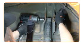
Entfernen Sie die Befestigungsschraube.
