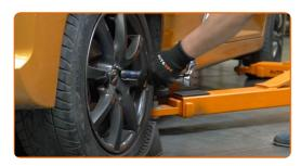
Entfernen Sie den Wagenheber sowie die Unterlegkeile.
