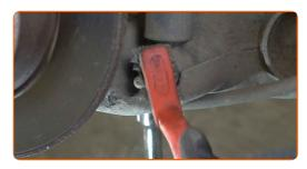
Schrauben Sie den unteren Befestiger des Stoßdämpfers ab. Verwenden Sie Stecknuss Nr. E16. Verwenden Sie einen Ratschenschlüssel.
