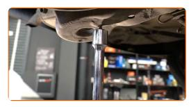
Reinigen Sie die Stoßdämpferbefestigungen. Benutzen Sie eine Drahtbürste. Benutzen Sie WD-40-Spray.
