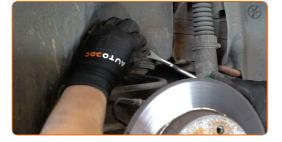
Entfernen Sie die Radkastenabdeckung.
