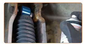
Ziehen Sie den unteren Befestiger des Stoßdämpfers an. Verwenden Sie Stecknuss Nr. E16. Verwenden Sie einen Drehmomentschlüssel. Ziehen Sie ihn mit 100 Nm Drehmoment fest.
