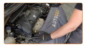
Schrauben Sie das Verbindungsteil der Motorhaube ab. Verwenden Sie Stecknuss Nr. 8. Verwenden Sie einen Ratschenschlüssel.
