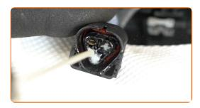
Schließen Sie die Stecker der Zündspulen an. Stellen Sie sicher, dass Sie dabei das Klicken hören, welches entsteht, wenn sich diese in der korrekten Position befindet.
