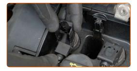
Entnehmen Sie die Zündspule aus der Vertiefung für die Zündkerze.
