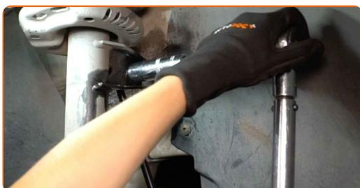
**13** Ziehen Sie das Befestigungselement an, das die Druckstange mit dem Stabilisator verbindet. Verwenden Sie Ring-Gabelschlüssel Nr. 15. Verwenden Sie Stecknuss Nr. 19. Verwenden Sie einen Drehmomentschlüssel. Ziehen Sie ihn mit 60 Nm Drehmoment fest.
