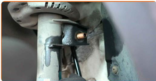
**12** Ziehen Sie das Befestigungselement an, das die Druckstange mit dem Federbein verbindet. Verwenden Sie Ring-Gabelschlüssel Nr. 15. Verwenden Sie Stecknuss Nr. 19. Verwenden Sie einen Drehmomentschlüssel. Ziehen Sie ihn mit 60 Nm Drehmoment fest.
