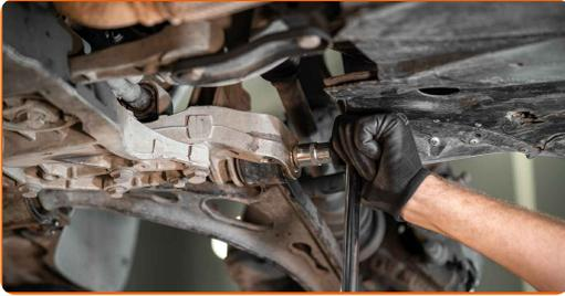
11 Schrauben Sie die hintere Armbefestigung ab. Verwenden Sie Stecknuss Nr. 16, Nr. 18.
