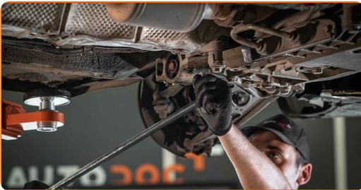
12 Entfernen Sie den Arm. Benutzen Sie ein Brecheisen.
