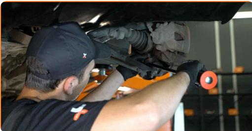
13 Reinigen Sie die Montagebohrungen und die Gewinde des Querlenkers. Benutzen Sie eine Drahtbürste. Benutzen Sie WD-40-Spray.
