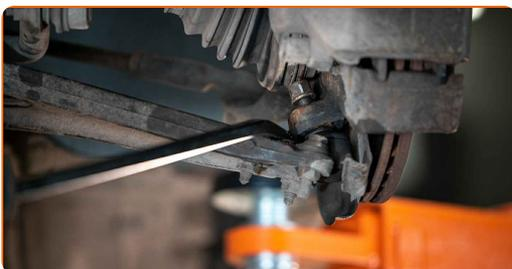
10 Schrauben Sie die vordere Armbefestigung ab. Verwenden Sie Stecknuss Nr. 18 oder Ringschlüssel Nr. 18.
