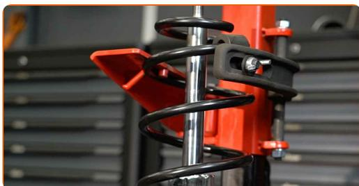
**31** Bringen Sie das Stützlager, die Manschette und den Anschlagpuffer auf dem Stoßdämpfer an.
