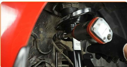
**8** Entfernen Sie die Halterung des ABS-Kabelbaums.
