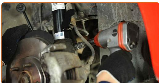
**14** Entfernen Sie die Befestigungsschraube.
