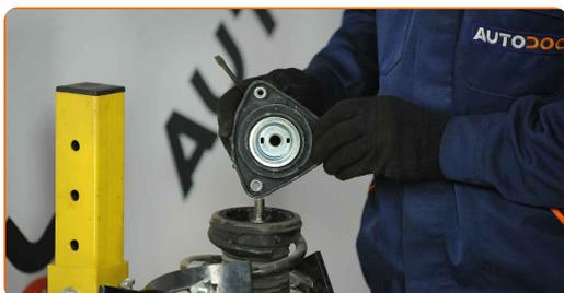
**32** Ziehen Sie die Federbeinkolbenstangenmutter an. Verwenden Sie Ring-Gabelschlüssel Nr. 18. Verwenden Sie Inbusschlüssel Nr. H6. Verwenden Sie einen Drehmomentschlüssel. Ziehen Sie ihn mit 60 Nm Drehmoment fest.
