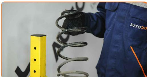
**29** Installieren Sie die Feder am Stoßdämpfer.
