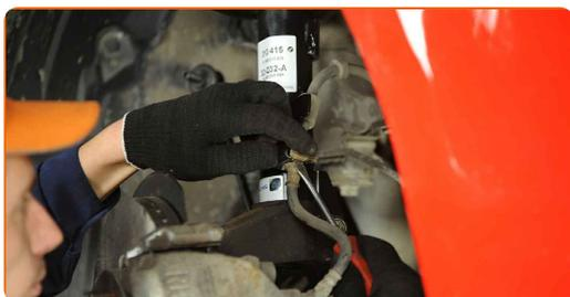
**11** Lösen Sie den Bremsschlauch vom Federbein.
