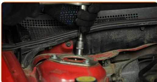
**39** Behandeln Sie die Befestigungselemente des Federbeinstützlagers. Benutzen Sie ein Kupferschmiermittel.
