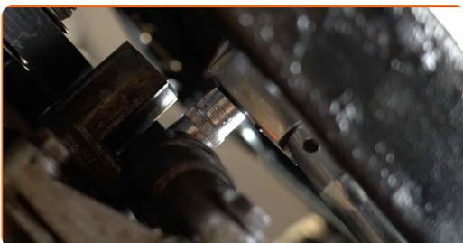
**14** Drehen Sie das Befestigungselement der Spannrolle des Klimakompressors ein. Verwenden Sie Stecknuss Nr. 13. Verwenden Sie einen Drehmomentschlüssel. Ziehen Sie ihn mit 7 Nm Drehmoment fest.
