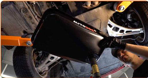
6 Lockern Sie die Befestigungsklemme der Kraftstofffilterleitung. Verwenden Sie Stecknuss Nr. 7. Verwenden Sie einen Ratschenschlüssel.
