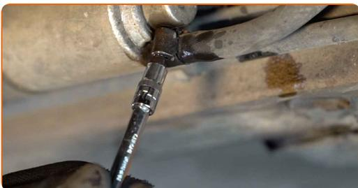
7 Lösen Sie die Schläuche vom Kraftstofffilter. Verwenden Sie eine Rundzange.
