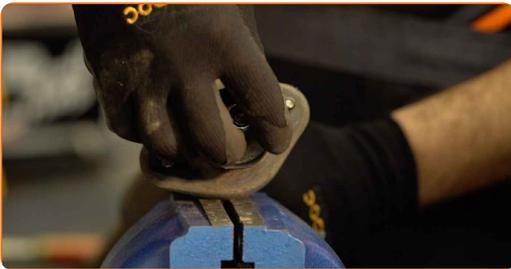
20 Entfernen Sie die Stoßdämpferhalterung, die Manschette und den Stoßstopp.
