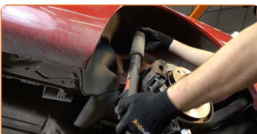
16 Greifen Sie den Stoßdämpfer mit einem Schraubstock.
