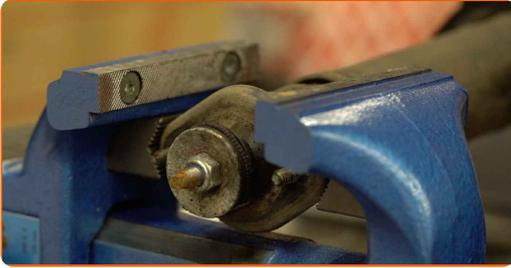
17 Reinigen Sie die Befestigungen vom Stoßdämpferschaft. Benutzen Sie eine Drahtbürste.
