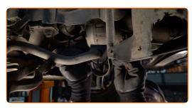
Schrauben Sie die Befestigungen der Stabilisatorbuchsenhalter ein. Verwenden Sie Stecknuss Nr. 16. Verwenden Sie einen Drehmomentschlüssel. Ziehen Sie ihn mit 28 Nm Drehmoment fest.
