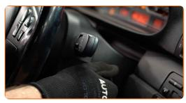
Schalten Sie die Zündung ab. Im Wartungsmodus befinden sich die Wischer in der oberen Position.
