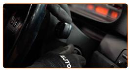
Ziehen Sie den Scheibenwischer-Hebel in die nach unten gerichtete Position. Auf diese Weise schalten Sie die Scheibenwischer vom Wartungs- in den Betriebsmodus um.
