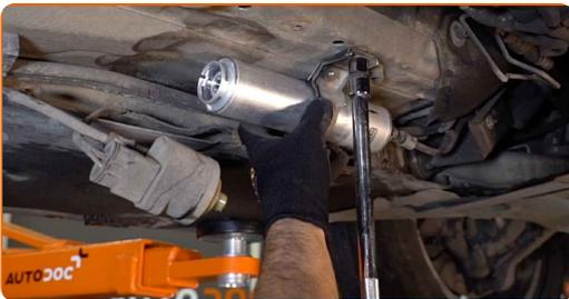
21 Verbinden Sie den Kraftstoffdruckregler mit dem Kraftstofffilter. Bringen Sie den Sprengring der Halteklammer des Kraftstoffdruckreglers an.
