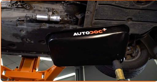
23 Installieren Sie die Schutzabdeckung.
