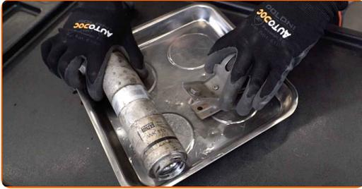
15 Installieren Sie einen neuen Kraftstofffilter.
