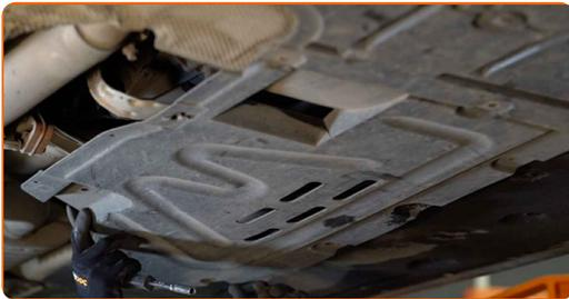
24 Ziehen Sie die Befestigungsschrauben der Schutzabdeckung fest. Verwenden Sie Stecknuss Nr. 8. Verwenden Sie einen Ratschenschlüssel.
