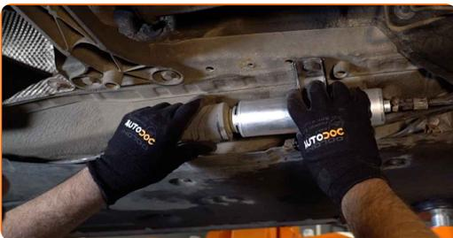
22 Den Flüssigkeitsbehälter unter dem Kraftstofffilter entfernen.
