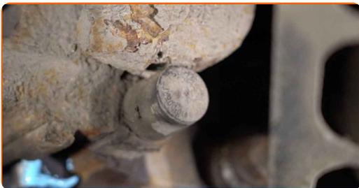
**34** Verbinden Sie den Bremsbelag-Verschleiß-Sensor.
