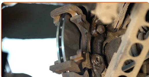
**28** Befestigen Sie die Bremssattelhalterung. Verwenden Sie Stecknuss Nr. 17. Verwenden Sie einen Drehmomentschlüssel. Ziehen Sie ihn mit 65 Nm Drehmoment fest.
