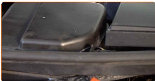
**44** Entfernen Sie die Kotflügel-Abdeckung.
