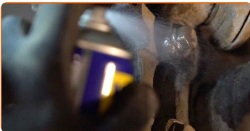
**18** Lösen Sie die Befestigung der Sattelhalterung. Verwenden Sie Stecknuss Nr. 17. Verwenden Sie ein Windeisen.
