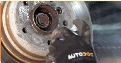
**21** Lösen Sie die Befestigung der Bremsscheibe. Verwenden Sie Inbusschlüssel Nr. H5. Verwenden Sie einen Schlagschrauber.
