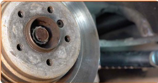
**20** Reinigen Sie die Befestigungselemente der Bremsscheibe. Benutzen Sie eine Drahtbürste. Benutzen Sie WD-40-Spray.
