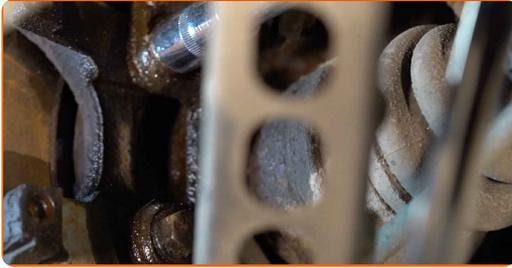
**19** Entfernen Sie die Sattelhalterung.
