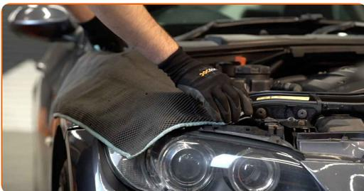
**3** Entfernen Sie die Wischerarm-Abdeckung.
