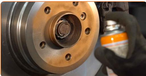
**37** Die Bremsscheibenoberfläche reinigen. Benutzen Sie einen Bremsenreiniger.
