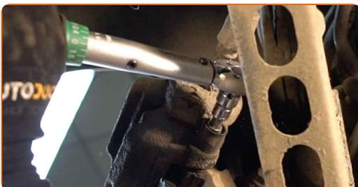
**33** Installieren Sie die Staubschutzkappen der Bremssattel-Führungsstifte.
