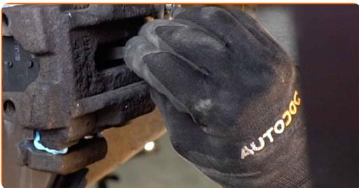
**35** Bauen Sie die Bremssattel-Haltefeder ein. Benutzen Sie ein Brecheisen.
