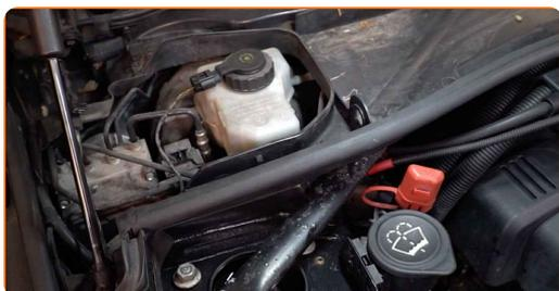
**8** Lösen Sie die Elektroverkabelung vom oberen Bereich des Mikrofilter-Gehäuses.
