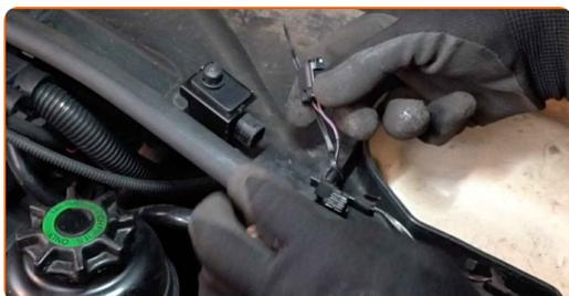
**7** Entfernen Sie die Climate-Control-Sensoren.
