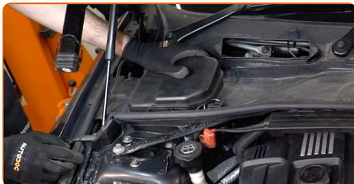
**34** Installieren Sie den Gehäusedeckel des Innenraumfilters.
