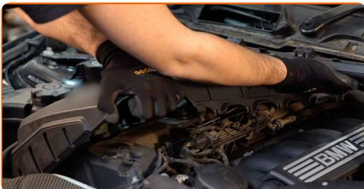
**14** Lösen Sie die Steckverbindung von den Zündspulen.
