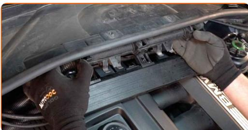
**29** Bringen Sie die Elektroverkabelung am oberen Bereich des Mikrofilter-Gehäuses an.
