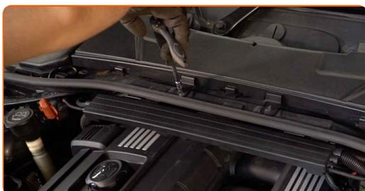
**4** Entfernen Sie den Gehäusedeckel des Innenraumfilters.
