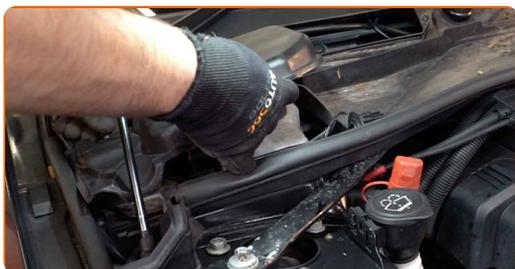
**6** Lösen Sie die Steckverbinder der Climate-Control-Sensoren.
