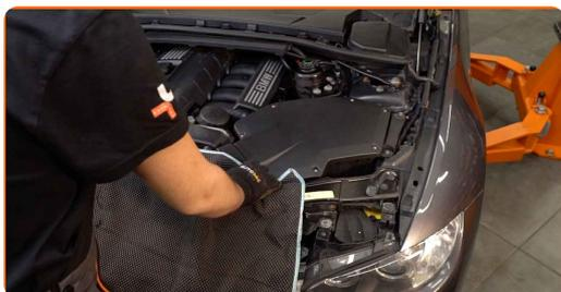
**3** Schrauben Sie die Verbindungselemente der Innenfilter-Gehäuseabdeckung ab. Verwenden Sie Stecknuss Nr. 8. Verwenden Sie einen Ratschenschlüssel.
