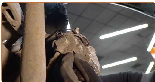
**11** Entfernen Sie den Bremssattel. Verwenden Sie einen flachen Schraubendreher.
