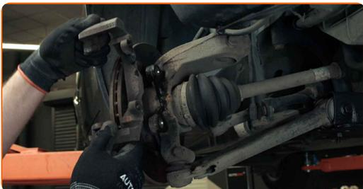
**17** Entfernen Sie die Bremsscheibe.
