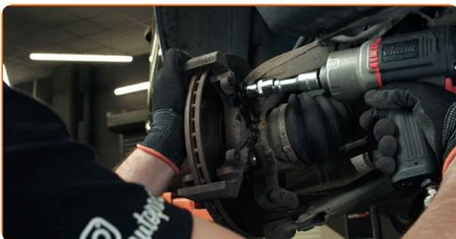
**15** Entfernen Sie die Befestigungsschrauben (2 Stück).
