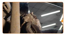
Entfernen Sie den Bremssattel. Verwenden Sie einen flachen Schraubendreher.
