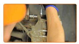
10 Entfernen Sie die Führungsstifte aus dem Bremssattel.
