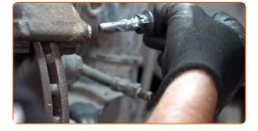
Ziehen Sie die Bremssattelbefestigungen fest. Verwenden Sie Ring-Gabelschlüssel Nr. 19. Verwenden Sie Stecknuss Nr. 13. Verwenden Sie einen Drehmomentschlüssel. Ziehen Sie ihn mit 30 Nm Drehmoment fest.
