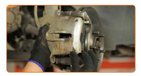
Behandeln Sie die Bremssattel-Führungsstifte. Verwenden Sie das Bremssattelführungsbolzen-Fett.
