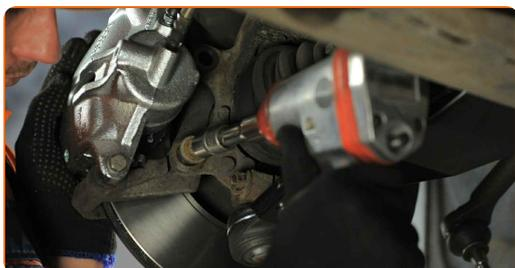
**8** Entfernen Sie die Befestigungsschrauben (2 Stück).
