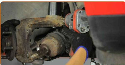
**25** Entfernen Sie die Befestigungsschraube.
