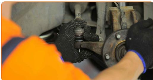
**48** Ziehen Sie die Befestigungsmutter an, die den Spurstangenkopf mit dem Achsschenkel verbindet. Verwenden Sie Stecknuss Nr. 17. Verwenden Sie einen Drehmomentschlüssel. Ziehen Sie ihn mit 40 Nm Drehmoment fest.
