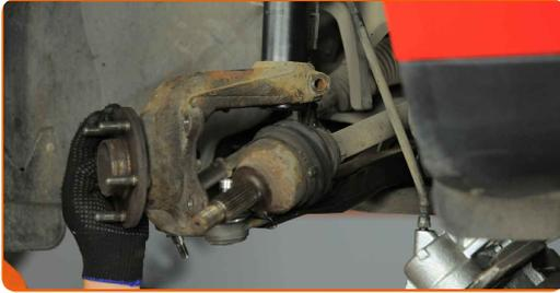
**26** Ziehen Sie den Achsschenkel vom Dämpferbein ab. Benutzen Sie einen Hammer.
