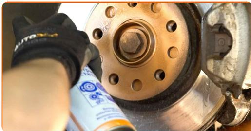
**57** Die Bremsscheibenoberfläche reinigen. Benutzen Sie einen Bremsenreiniger.
