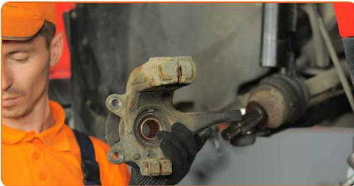
**28** Entfernen Sie die Radnabe vom Achsschenkel. Verwenden Sie einen Druckstücksatz mit Ein-/Auspresswerkzeug. Benutzen Sie einen Hammer.
