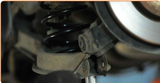
**21** Bringen Sie die Befestigungsschraube an. Verwenden Sie einen flachen Schraubendreher. Benutzen Sie einen Hammer.
