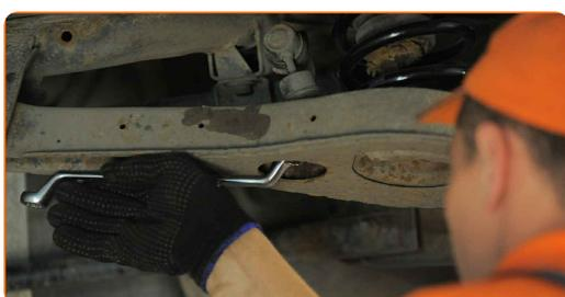
**27** Entfernen Sie den Träger unter der Achsschenkelachse.
