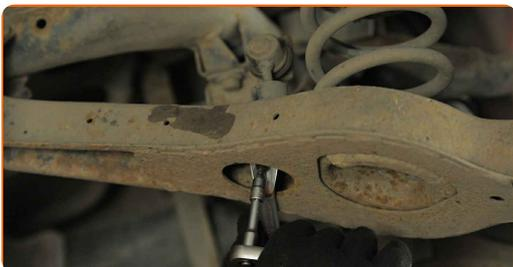
**10** Entfernen Sie die Befestigungsmutter.
