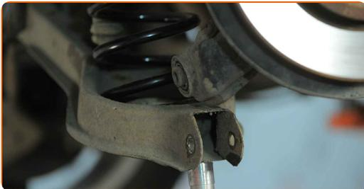
**20** Bringen Sie den Aufhängungsarm am hinteren Achsschenkel an. Verwenden Sie einen flachen Schraubendreher.
