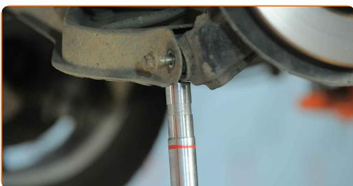
**13** Entfernen Sie die Befestigungsschraube.
