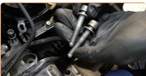
**12** Reinigen Sie den Montagesitz der Motoraufhängung. Benutzen Sie eine Drahtbürste. Benutzen Sie WD-40-Spray.
