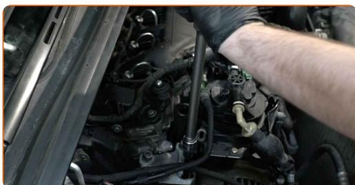
**20** Entfernen Sie den Träger unter dem Motor.
