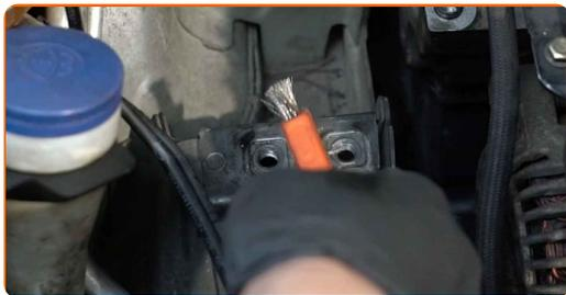
**13** Behandeln Sie die Befestigungen des Motorlagers. Verwenden Sie ein Dichtmittel.
