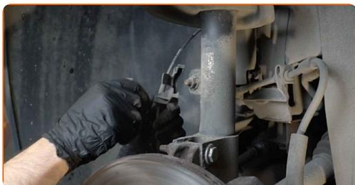
**21** Reinigen Sie die Befestigungen der Koppelstange. Benutzen Sie eine Drahtbürste. Benutzen Sie WD-40-Spray.
