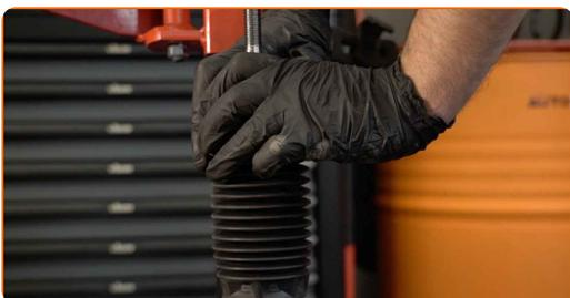
**41** Installieren Sie die Feder am Stoßdämpfer.
