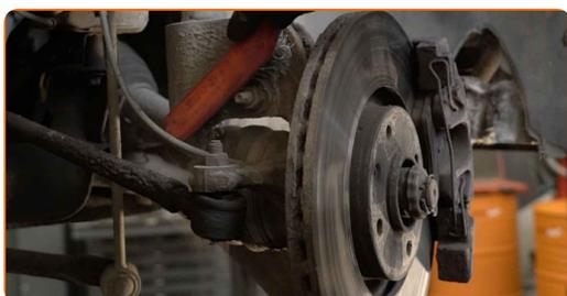
**25** Schrauben Sie das untere Befestigungselement ab, das das Federbein mit dem Achsschenkel verbindet. Verwenden Sie Ring-Gabelschlüssel Nr. 18. Verwenden Sie Stecknuss Nr. 18. Verwenden Sie einen Ratschenschlüssel.
