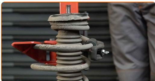
**34** Behandeln Sie die Federbeinstange. Benutzen Sie eine Drahtbürste. Benutzen Sie WD-40-Spray.
