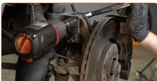
**26** Entfernen Sie die Befestigungsschraube.
