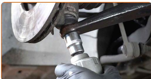
**64** Verbinden Sie den ABS-Sensor mit dem Achsschenkel.
