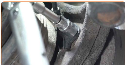
**66** Ziehen Sie das Kugelgelenk an. Verwenden Sie Stecknuss Nr. 21. Verwenden Sie einen Drehmomentschlüssel. Ziehen Sie ihn mit 50 Nm Drehmoment fest.
