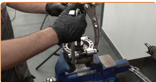
**37** Reinigen Sie den Sicherungsring des Radnabenlagers. Benutzen Sie eine Drahtbürste. Benutzen Sie WD-40-Spray.
