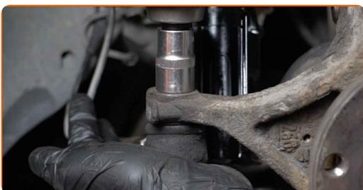
**52** Befestigen Sie das Dämpferbein auf dem Achsschenkel. Benutzen Sie ein Brecheisen.
