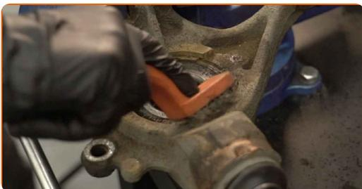
**38** Entfernen Sie den Sicherungsring am Radnabenlager. Verwenden Sie eine Sicherungsringzange.
