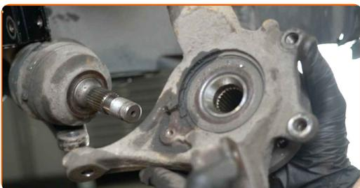
**35** Entfernen Sie die Radnabe vom Achsschenkel. Verwenden Sie einen Splintentreiber. Benutzen Sie einen Hammer.
