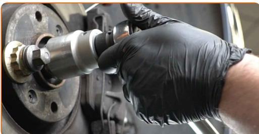
**62** Bauen Sie den Splint der Mutter der Antriebswelle ein. Benutzen Sie ein Brecheisen. Benutzen Sie einen Hammer.
