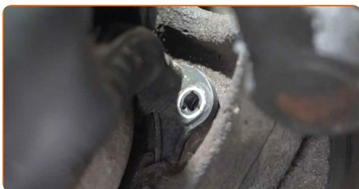
**65** Schrauben Sie die Befestigung, die den ABS-Sensor am Achsschenkel verbindet, fest. Verwenden Sie Stecknuss Nr. 10. Verwenden Sie einen Drehmomentschlüssel. Ziehen Sie ihn mit 11 Nm Drehmoment fest.
