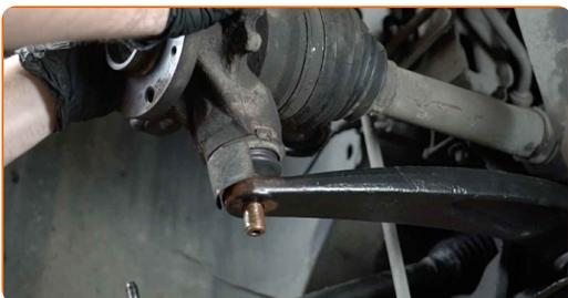
**50** Bauen Sie den Spurstangenkopf an dem Achsschenkel an.
