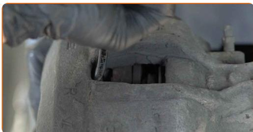
**19** Lösen Sie die Befestigung der Sattelhalterung. Verwenden Sie den Torx T50. Verwenden Sie ein Windeisen.
