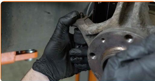
**51** Schrauben Sie die Befestigungsmutter auf, die den Spurstangenkopf mit dem Achsschenkel verbindet. Verwenden Sie Stecknuss Nr. 17. Verwenden Sie einen Ratschenschlüssel.
