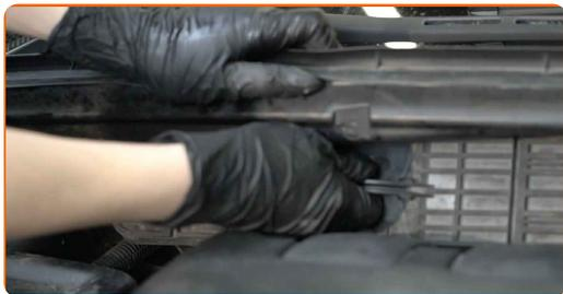
**4** Entfernen Sie das Filterelement aus dem Filtergehäuse.
