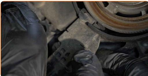
**45** Entfernen Sie die untere Zahnriemenabdeckung.
