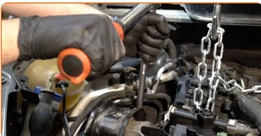
**114** Ziehen Sie die Befestigungsschrauben des Motorlagers an. Verwenden Sie den Torx T50. Verwenden Sie einen Drehmomentschlüssel. Ziehen Sie ihn mit 60 Nm Drehmoment fest.
