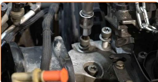
**112** Schrauben Sie die Befestigungen, die das Motorlager mit der Karosserie verbinden, ein. Verwenden Sie Stecknuss Nr. E14. Verwenden Sie einen Ratschenschlüssel.
