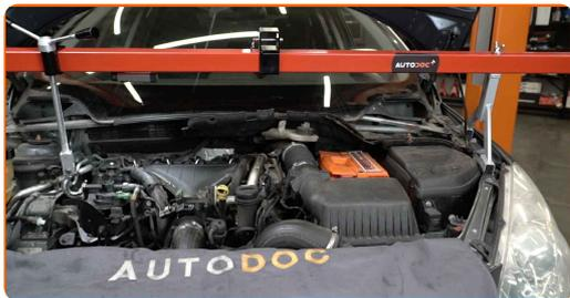
**17** Reinigen Sie die Motorlager-Befestigungen. Benutzen Sie eine Drahtbürste. Benutzen Sie WD-40-Spray.
