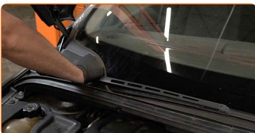
**7** Entfernen Sie die Befestigungsclips der Windlaufabdeckung. Verwenden Sie einen Lösehebel, um die Clips zu entfernen.
