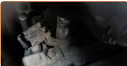
**44** Entfernen Sie den Kurbellwellensensor.
