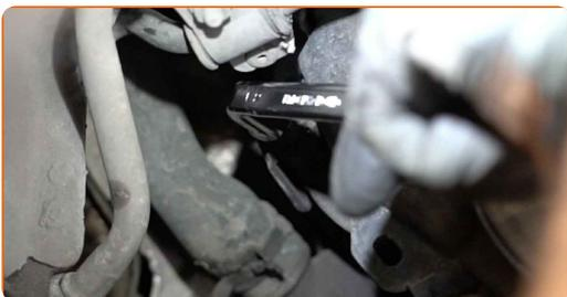
**32** Entfernen Sie die obere Zahnriemenabdeckung.
