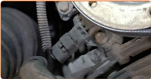
**30** Lösen Sie die Verkabelung des Kurbelwellensensors. Verwenden Sie einen Lösehebel, um die Clips zu entfernen.
