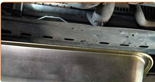
**57** Lösen Sie die Klemme der unteren Kühlmittleitung. Verwenden Sie eine Clic-R-Kragenzange.
