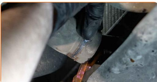
**59** Lassen Sie das Kühlmittel aus dem Motor ab.
