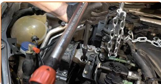
**115** Entfernen Sie die Motorbrücke.
