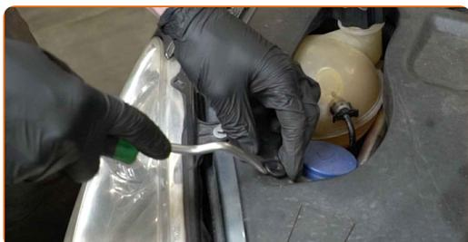
**12** Entfernen Sie die Schutzabdeckung des Kühlmittelbehälters.
