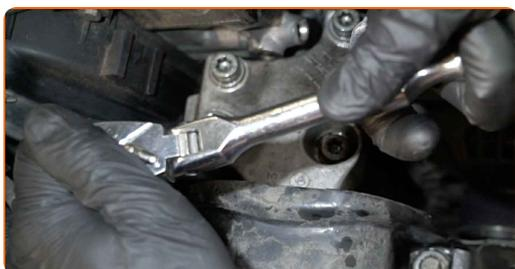
**19** Schrauben Sie die Befestigungen der Motoraufhängung heraus. Verwenden Sie den Torx T50. Verwenden Sie einen Ratschenschlüssel.
