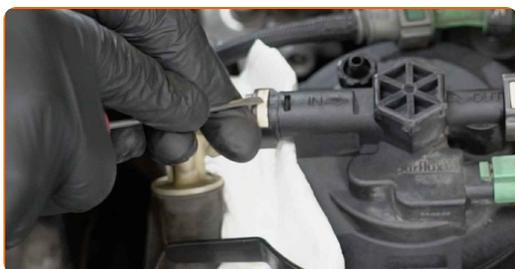
**15** Verschließen Sie die Kraftstoffleitungen mit Verschlüssen.
