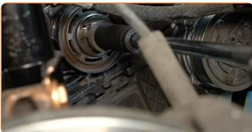
**87** Drehen Sie das Kurbelwellenrad. Verwenden Sie Stecknuss Nr. 22. Verwenden Sie einen Ratschenschlüssel.
