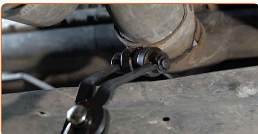
**58** Lösen Sie die untere Kühlmittleitung.
