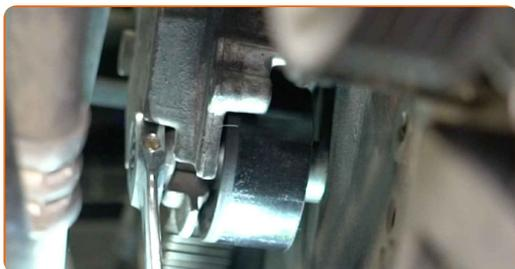
**55** Entfernen Sie die Umlenkriemenscheibe des Zahnriemens aus ihrer Montageposition.
