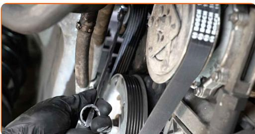
**34** Entfernen Sie den Keilrippenriemen.
