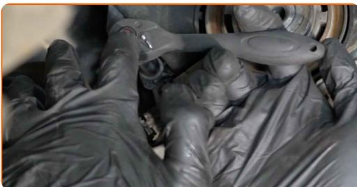
**43** Schrauben Sie die Befestigung des Kurbellwellensensors ab. Verwenden Sie Stecknuss Nr. 10. Verwenden Sie einen Ratschenschlüssel.
