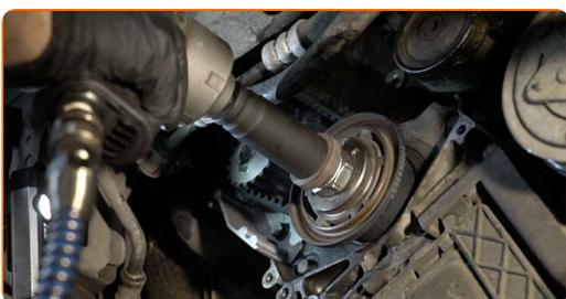
**89** Entfernen Sie die Befestigungsschraube.
