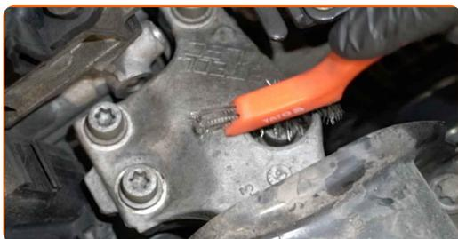
**18** Schrauben Sie die Befestigungen, die das Motorlager mit der Karosserie verbinden, ab. Verwenden Sie Stecknuss Nr. E14. Verwenden Sie einen Ratschenschlüssel.
