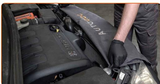
**3** Entfernen Sie die Batterieklemmen.
