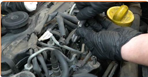
**16** Schrauben Sie die Glühkerzen fest. Verwenden Sie die Zündkerzennuss # 10. Verwenden Sie einen Drehmomentschlüssel. Ziehen Sie ihn mit 15 Nm Drehmoment fest.
