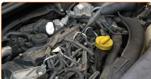
**11** Lösen Sie die Steckverbinder der Glühkerzenverkabelung.
