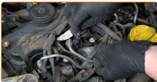
**12** Schrauben Sie die Glühkerzen aus. Verwenden Sie die Zündkerzennuss # 10. Verwenden Sie einen Ratschenschlüssel.
