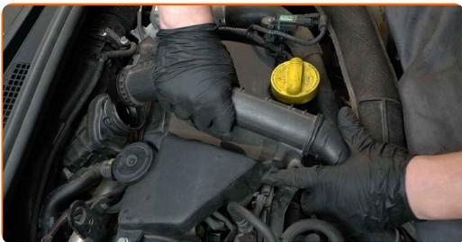
**23** Ziehen Sie die Klemme am Luftansaugschlauch fest. Verwenden Sie Kombinationszangen.
