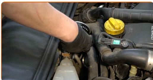
**16** Schrauben Sie den neuen Filter in seinen Platz. Verwenden Sie Steckschlüssel 76-14F. Verwenden Sie einen Drehmomentschlüssel. Ziehen Sie ihn mit 25 Nm Drehmoment fest.
