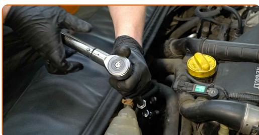
**17** Verbinden Sie das Luftansaugrohr mit dem Luftfilter-Gehäuse.
