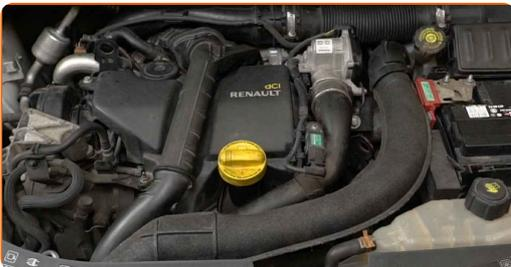
**29** Überprüfen Sie den Ölstand 5 Minuten nach dem Anhalten des Motors, verwenden Sie einen Peilstab und fügen Sie - wenn nötig - Öl hinzu.
