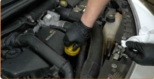
**28** Lassen Sie den Motor ein paar Minuten laufen. Nachdem die Ölstands-Warnleuchte erloschen ist, stoppen Sie den Motor.
