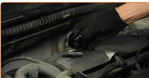
**24** Befestigen Sie den Deckel des Öleinfüllstutzens.
