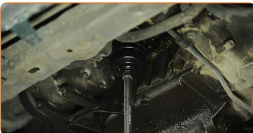
**15** Reinigen Sie den Bereich um die Ablassöffnung der Ölwanne.
