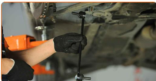
**12** Ziehen Sie das Befestigungselement an, das die Druckstange mit dem Stabilisator verbindet. Verwenden Sie Ring-Gabelschlüssel Nr. 19. Verwenden Sie Inbusschlüssel Nr. H6. Verwenden Sie einen Drehmomentschlüssel. Ziehen Sie ihn mit 65 Nm Drehmoment fest.
