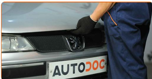
**29** Verwenden Sie eine Kotflügel-Schutzabdeckung, um Schäden an der Lackierung und den Kunststoffteilen des Autos zu verhindern.
