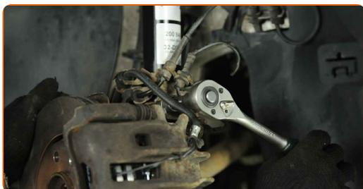
**62** Montieren Sie den Querlenker.
