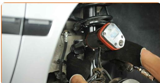
**64** Bauen Sie den Spurstangenkopf an dem Achsschenkel an.
