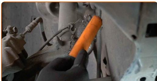
**23** Schrauben Sie das untere Befestigungselement ab, das das Federbein mit dem Achsschenkel verbindet. Verwenden Sie Stecknuss Nr. 16. Verwenden Sie einen Ratschenschlüssel.
