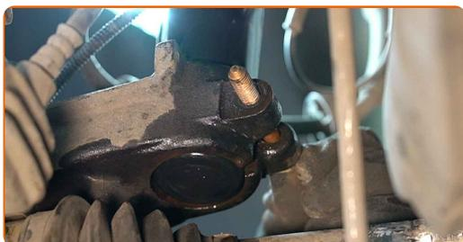
**52** Schrauben Sie die unteren Befestigungen des Federbeins fest. Verwenden Sie Stecknuss Nr. 16. Verwenden Sie einen Drehmomentschlüssel. Ziehen Sie ihn mit 55 Nm Drehmoment fest.
