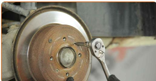
**17** Entfernen Sie die Bremsscheibe.
